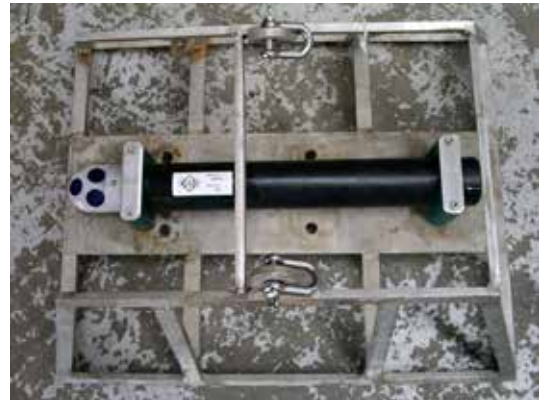
Photo d'un appareil de mesure de vitesse par ADCP
