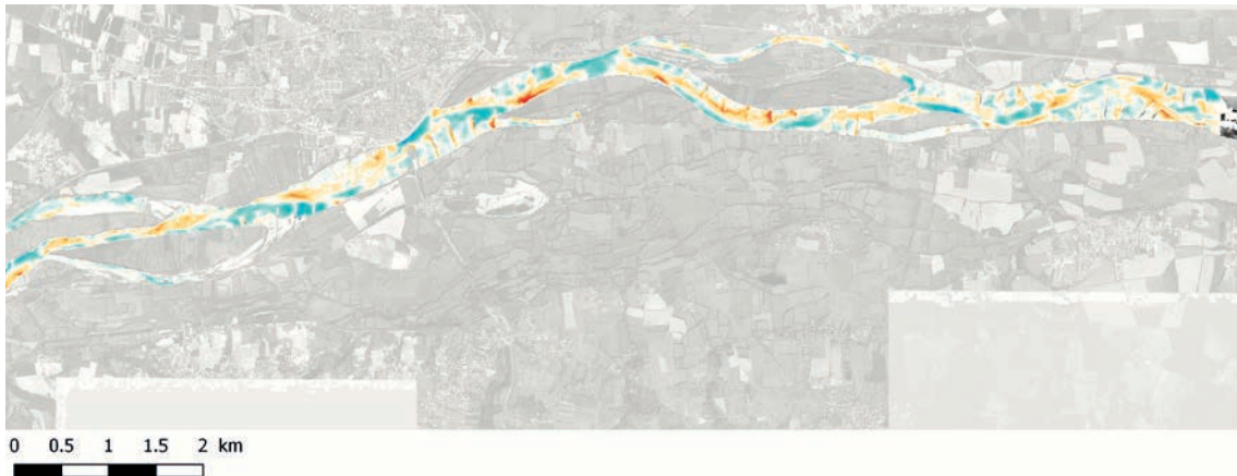
Exemple de carte de travail : Résultat de l'évolution des fonds sur la période de calage : 2010-2013 sur le secteur Oudon-Saint-Florent
